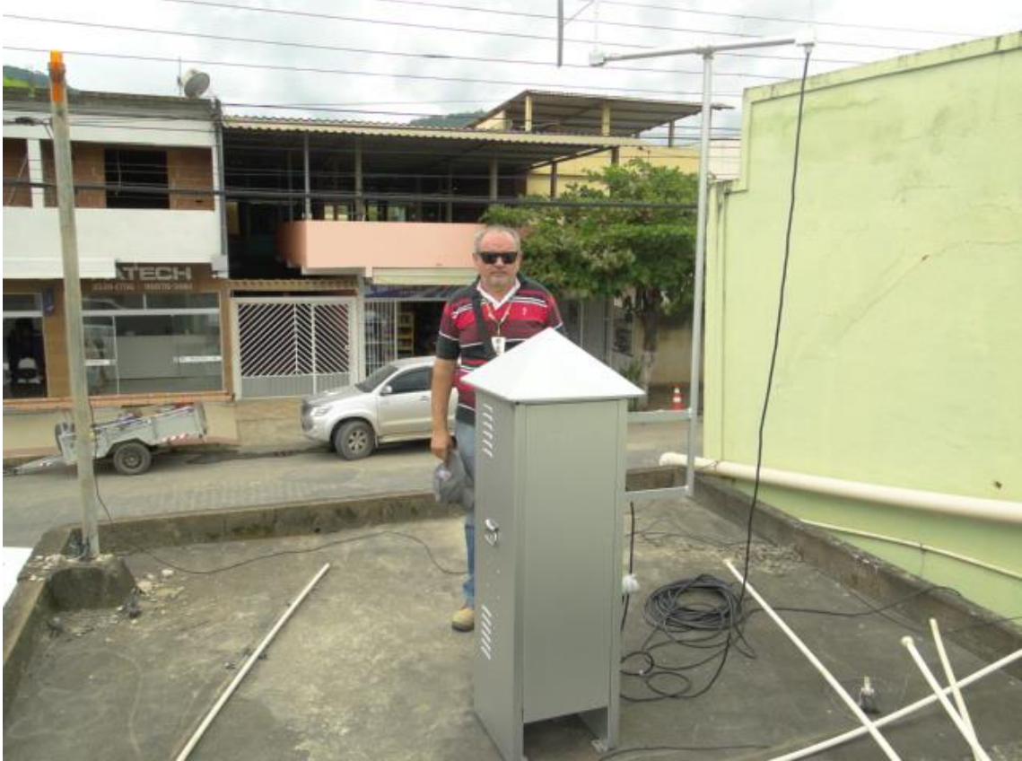
Figura 2 - Amostrador de Grande Volume para PTS com estação meteorológica
