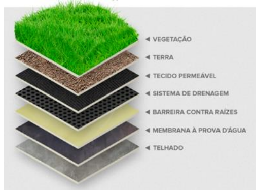
Figura 69: Esquema de uma cobertura verde
