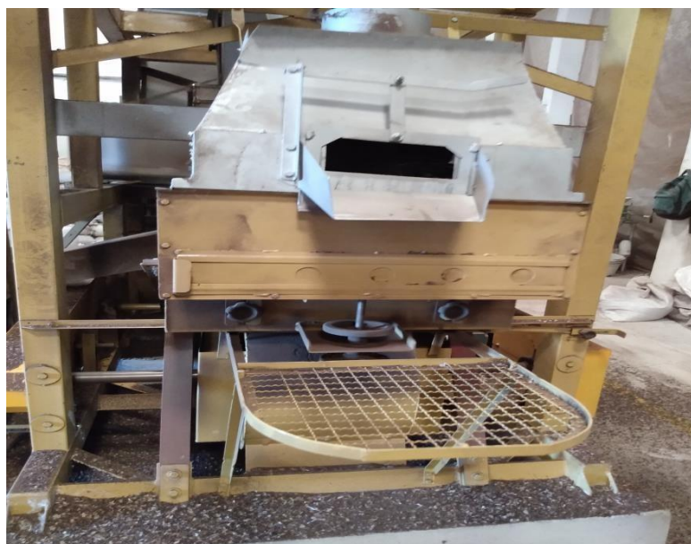
Figura 5 - Separador de Pedras Fonte: Elaborada pelo Autor
