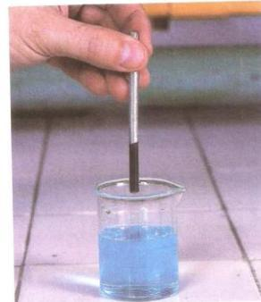
No pedaço de zinco que foi imerso há depósito de cobre metálico.
