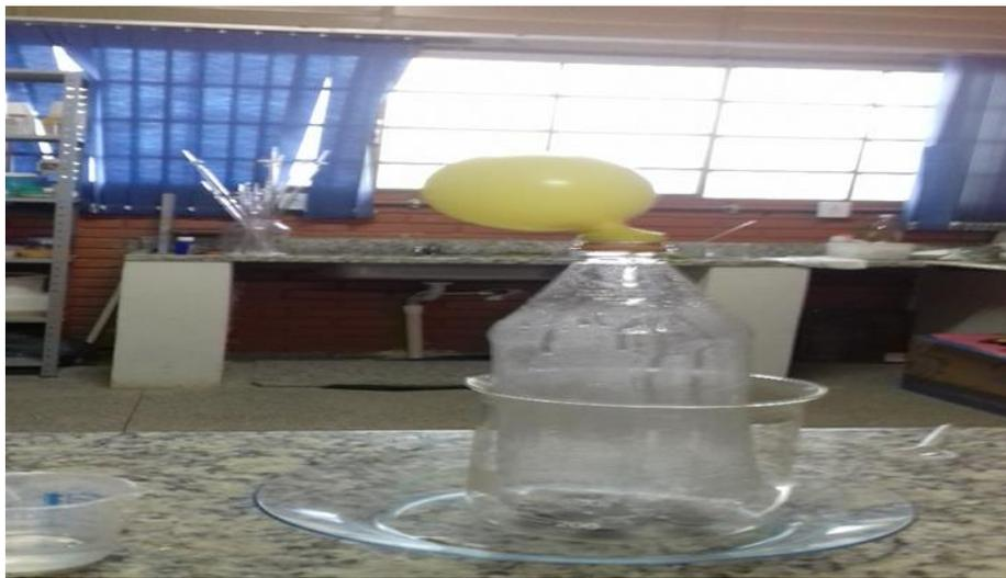
Figura 11 - Reação química entre o alumínio e o hidróxido de sódio com formação de gás hidrogênio.
