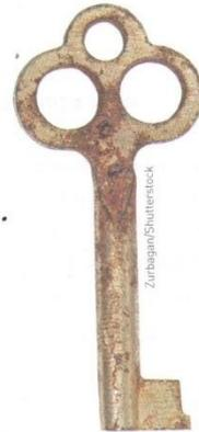
A ferrugem é o resultado de um processo de corrosão que ocorre quando o ferro reage com o oxigênio do ar em presença de umidade.
