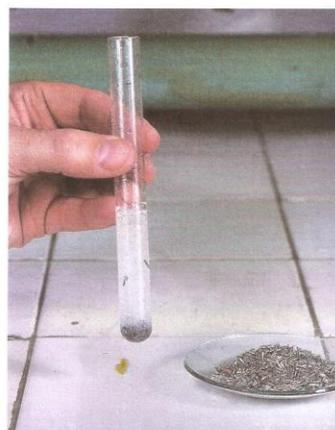
Já é possível observar a formação moderada de bolhas de gás no interior do tubo de ensaio.
