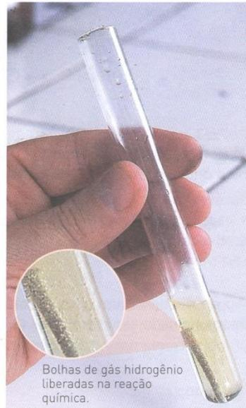
Reação do ácido clorídrico com o ferro, causando corrosão.
