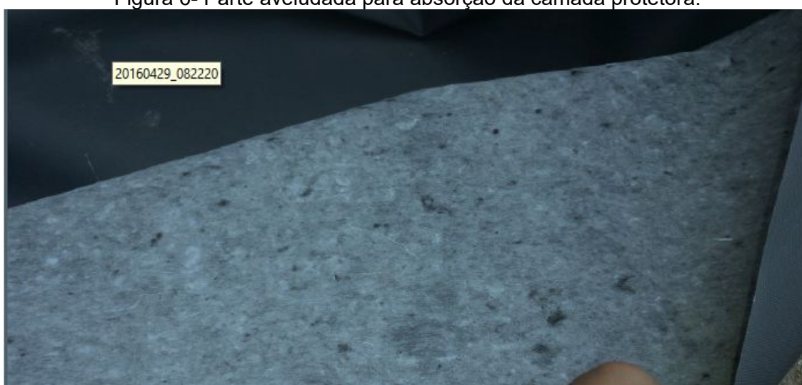
Figura 6- Parte aveludada para absorção da camada protetora.
