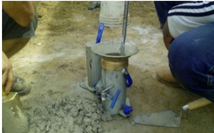
Figura 9 - Moldagem dos corpos de prova
