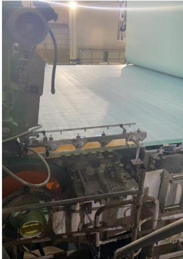
**Anexo 6** – Alimentação pneumática das facas da rebobinadeira antes das ações
