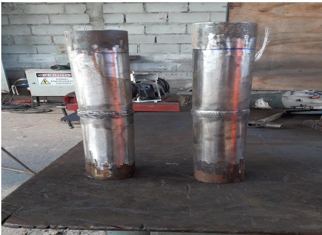
Figura 11 – Corpos de Provas (Processo ER tubo lado esquerdo e TIG tubo lado direito)
