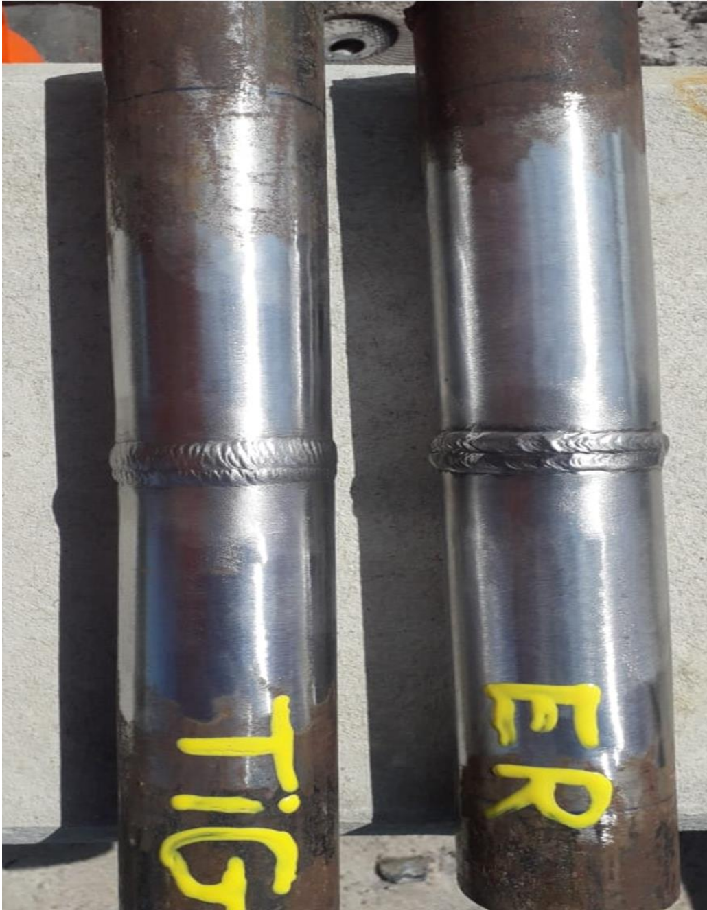
Figura 20 – Corpos de Provas soldados pelo processo TIG (tubo lado esquerdo) e processo ER (tubo lado direito)
