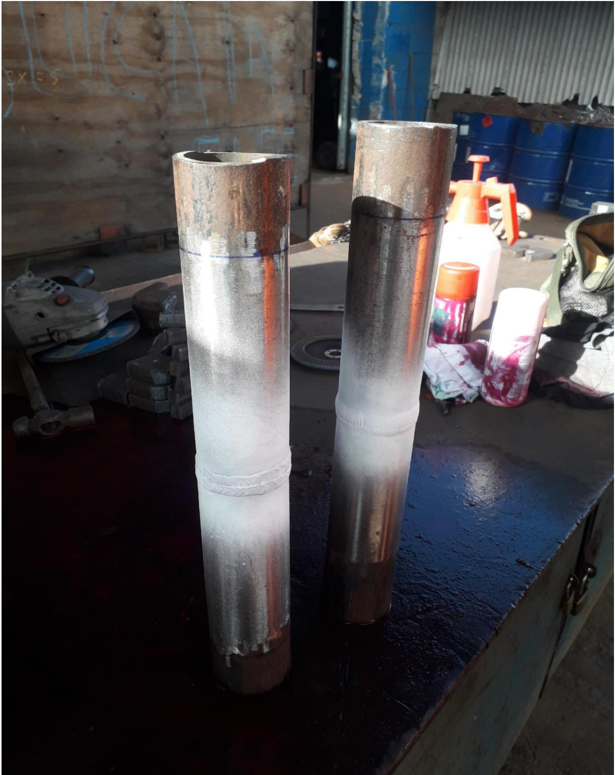
Figura 15 – Inspeção por Líquido Penetrante
