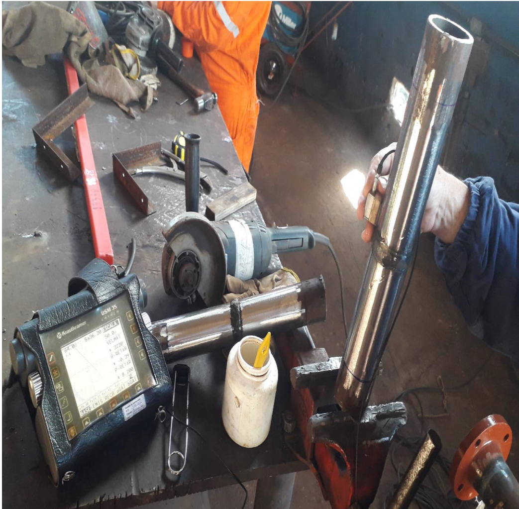
Figura 17 – Inspeção por ultrassom
