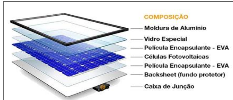
Figura 8 - Composição Módulo Fotovoltaico
