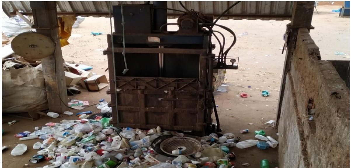
Figura 6 - Prensa hidráulica vertical utilizada pela ASCAP para proceder o enfardamento dos materiais recicláveis
