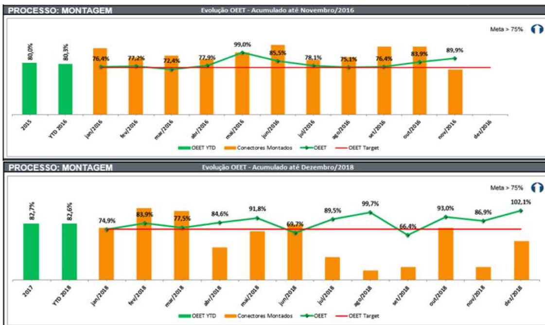
Gráfico 3 - Percentual do OEE dos anos de 2015 - 2016 e nos anos 2017-2018 no setor de montagem.
