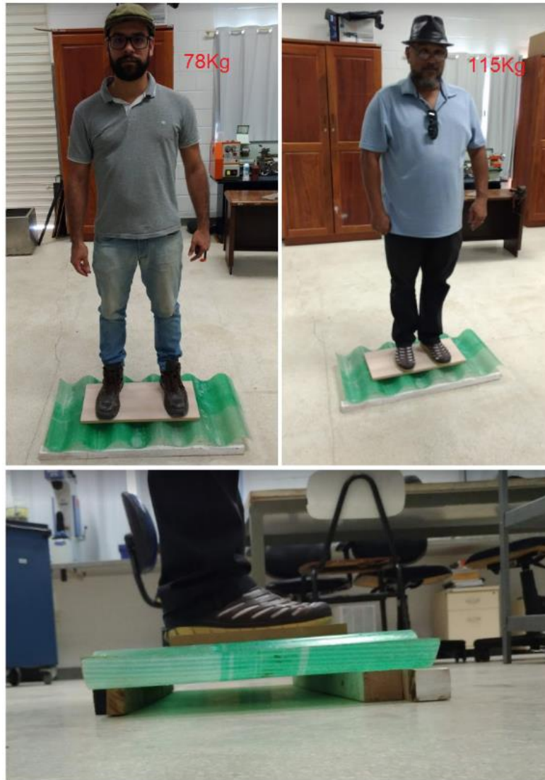
Figura 68 - Teste de carga estática com apoios sendo realizada no protótipo
