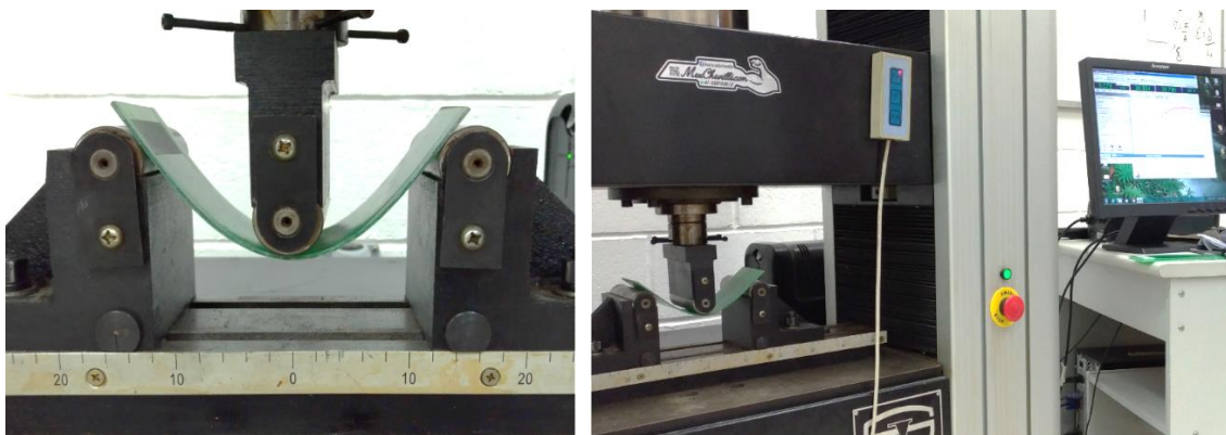
Figura 40 - Corpo de prova sendo submetido ao ensaio de flexão
