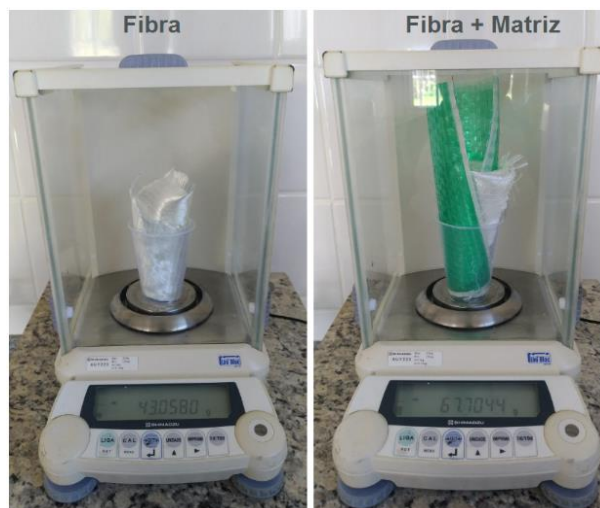
Figura 31 - Pesagem das fibras e matriz
