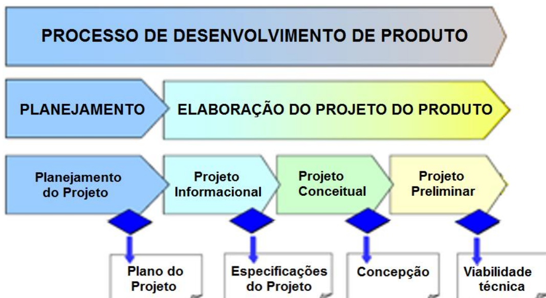
Figura 22 - Representação do modelo de processo de desenvolvimento de produtos
