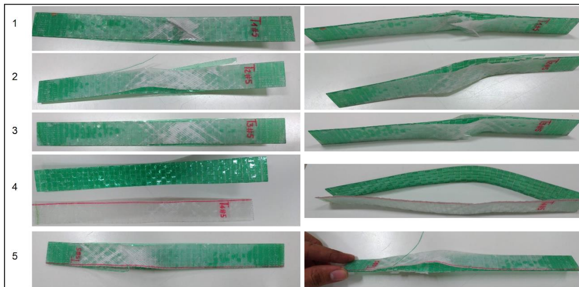
Figura 56 - Macro aspecto dos corpos de prova de tração após o ensaio realizado
