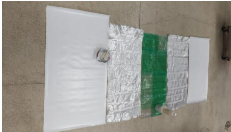
Figura 54 - Preparação dos materiais para laminação da telha de PET
