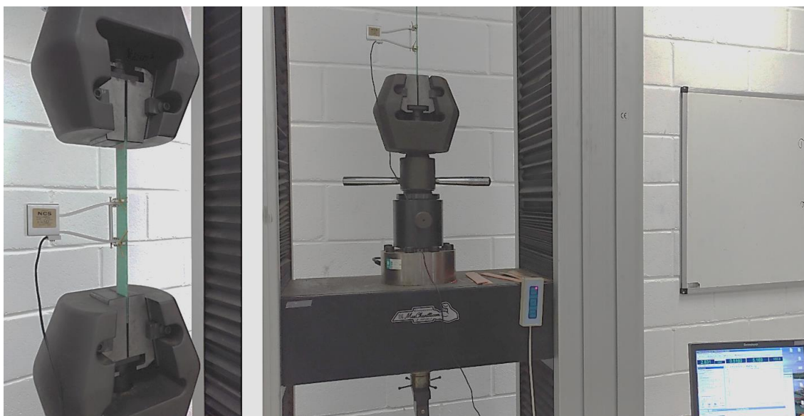
Figura 38 - Corpo de prova sendo submetido ao ensaio de tração
