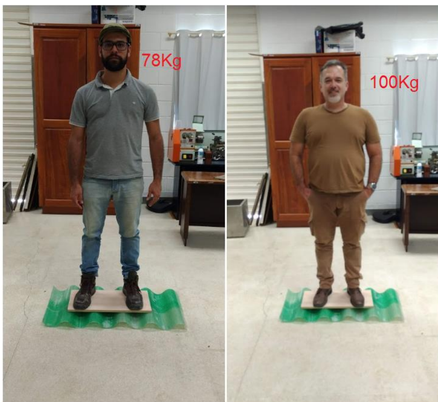
Figura 67 - Teste de carga estática sendo realizada no protótipo
