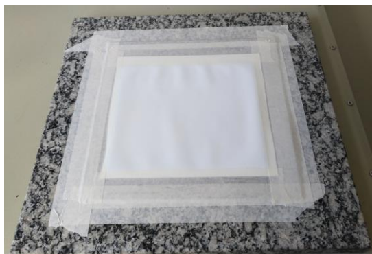
Figura 30 - Fixação do polipropileno no granito liso
