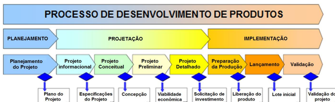
Figura 5 - Representação gráfica do modelo do processo de desenvolvimento integrado de produtos
