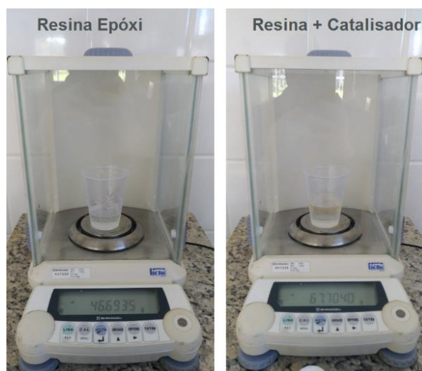
Figura 32 - Pesagem da resina e catalisador
