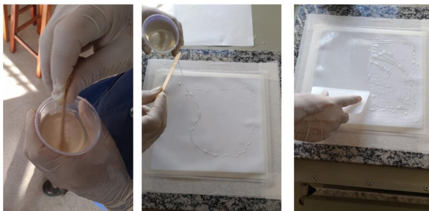
Figura 34 - Primeira camada de resina epóxi
