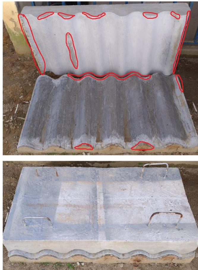
Figura 64 - Resultado final dos moldes para laminação do compósito
